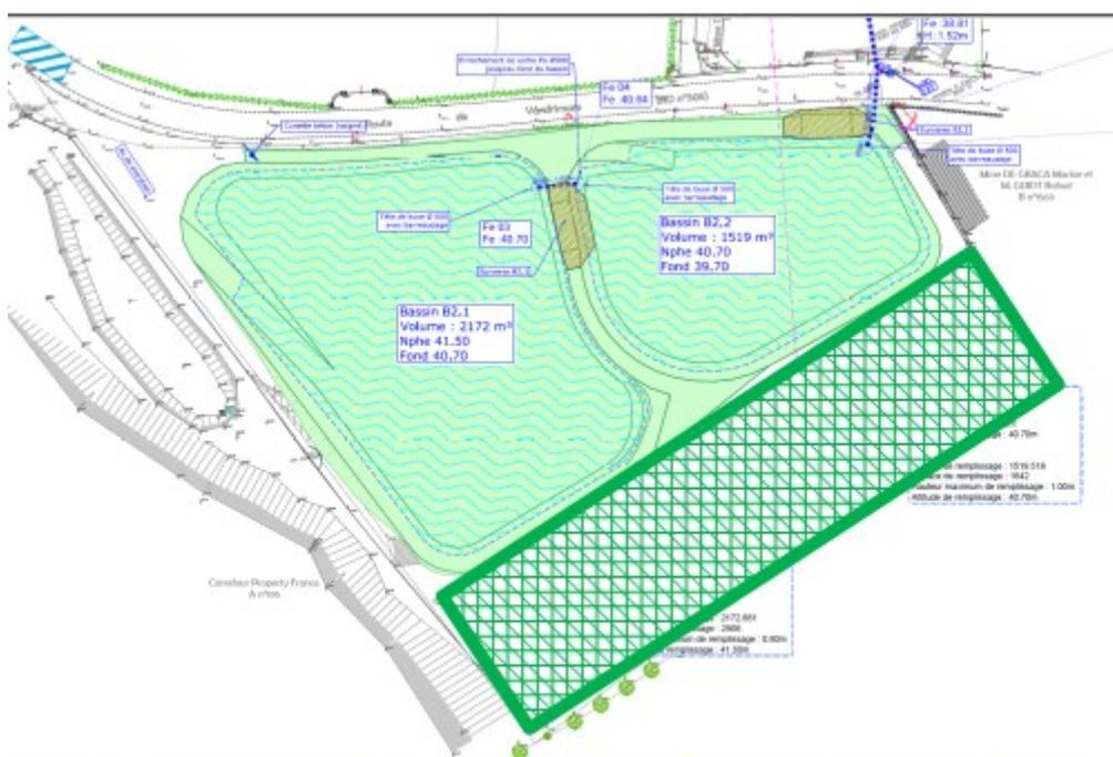
Figure 6 : emprise de l'ouvrage Essart 2 concernée par un boisement (surface 2 500 m<sup>2</sup>)
